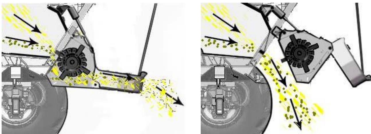
Рисунок 6. Процесс измельчения и разбрасывания соломы
